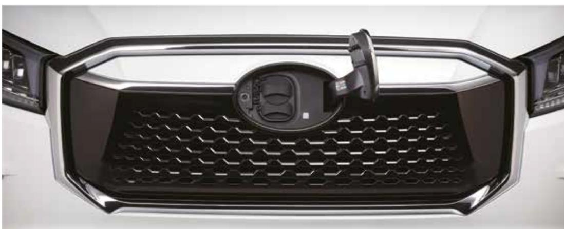
Le eDeliver9 peut se recharger de différentes façons. Le véhicule est équipé d'un **chargeur interne** permettant une **recharge en courant alternatif monophasé ou triphasé**, et d'une fonction de **recharge rapide** en courant continu.
